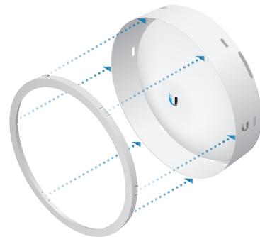
Installation Using the IsoBeam<sup>™</sup>
