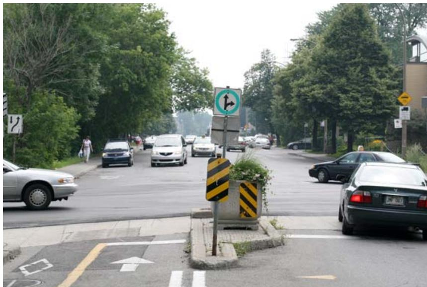
**Fig. 5 : Rétrécir la largeur de la chaussée à peu de frais (rue Laurier)**
