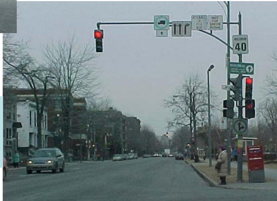
Et à plusieurs endroits il y a des cycles séparés pour piétons, et on les fait traverser sur le feu rouge. Avec un cycle pour piétons sur feu rouge pour la période d'engagement de 9 secondes, en tout temps, 24 h /24
