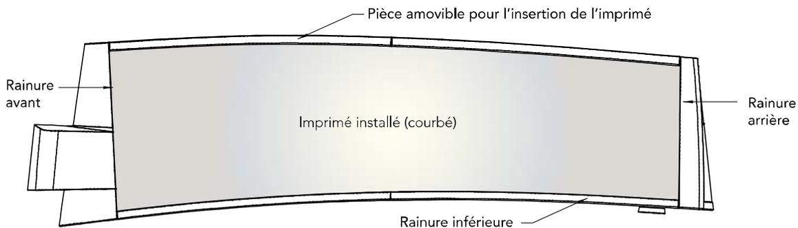
Le visuel doit être imprimé jusqu'aux limites du support mais les bordures illustrées ci-dessous (12.7mm (1/2") au bas et de chaque côté) sont cachées par les rainures du module (avant, arrière et inférieure).
