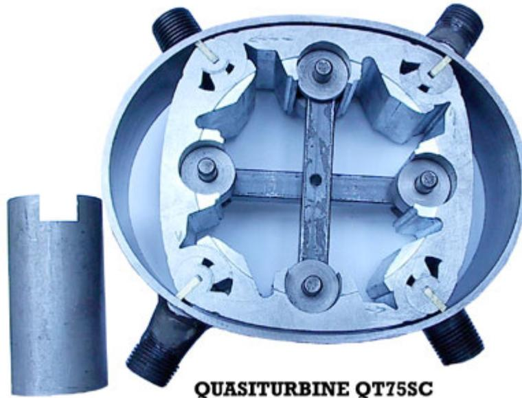
**Une grande flexibilité** au niveau du choix des combustibles utilisables : pétrole, huile végétale, alcool, gaz naturel, hydrogène, etc. De plus, la Quasiturbine peut fonctionner en mode pneumatique, c'est-à-dire en acceptant à l'entrée un fluide comprimé comme de l'air, de l'azote, de la vapeur, etc. À long terme, elle offre la possibilité d'une opération mixte pneumatique en ville et carburant en longue autonomie.
