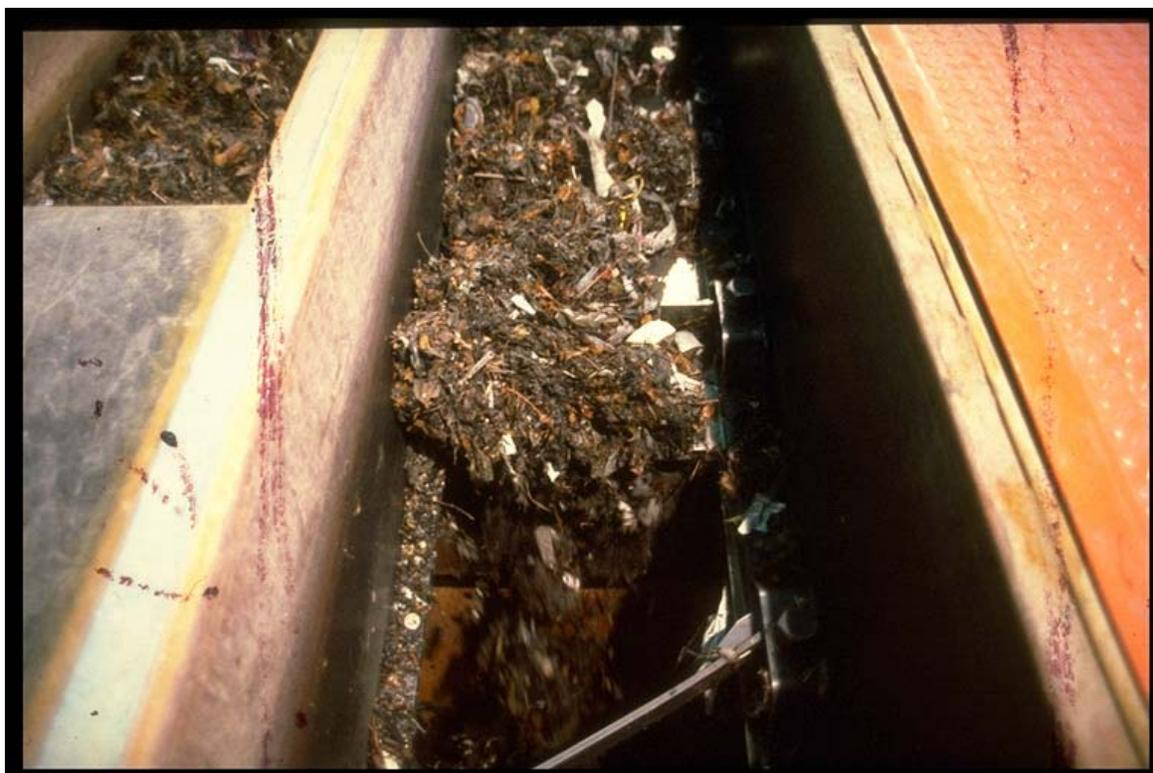
**Figure 11 Résidus des grilles (convoyeur à palettes)**
