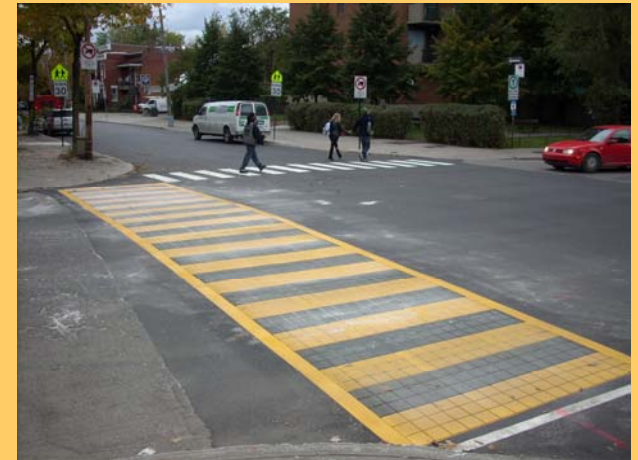
Passage piétons texturé avec marquage permanent
