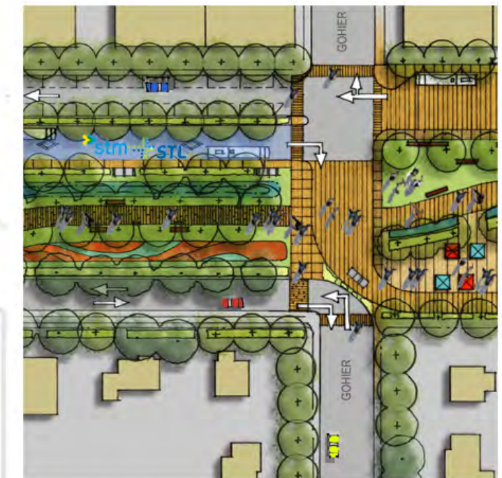
Aménagement du pavé surélevé reliant la place publique au parc linéaire et à la piste multimodale
