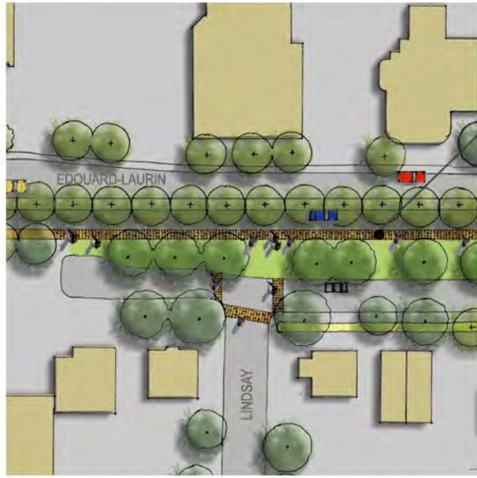
Aménagement de trottoir du côté sud d'Edouard-Laurin reliant l'entrée Ouest du parc linéaire à Marcel-Laurin
