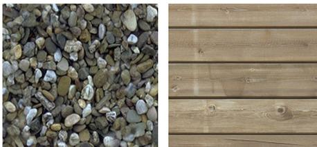
Matériaux perméables suggérés pour la surface d'accès au CSP sur socle
