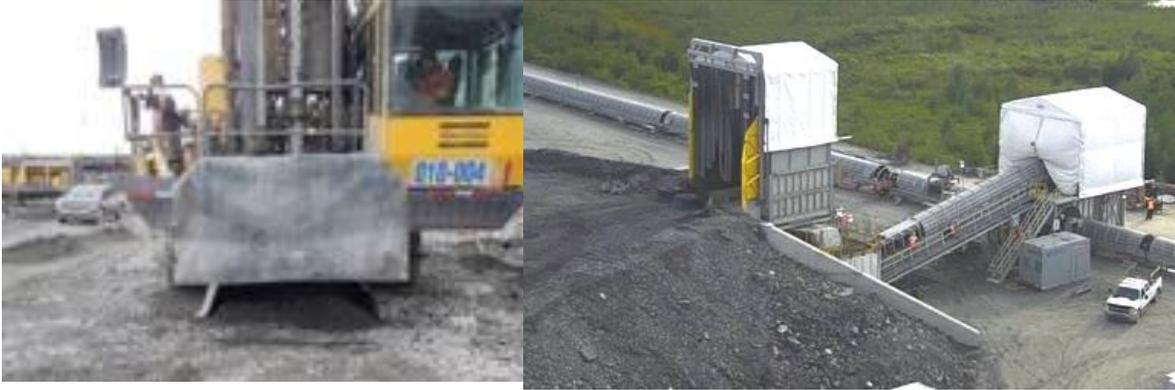
*Jupette de caoutchouc sur une foreuse à droite, et abris sur les composantes productrices de poussière à droite.*
