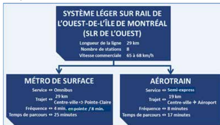
▲ Figure 7,14 : Les différents systèmes du SLRO
