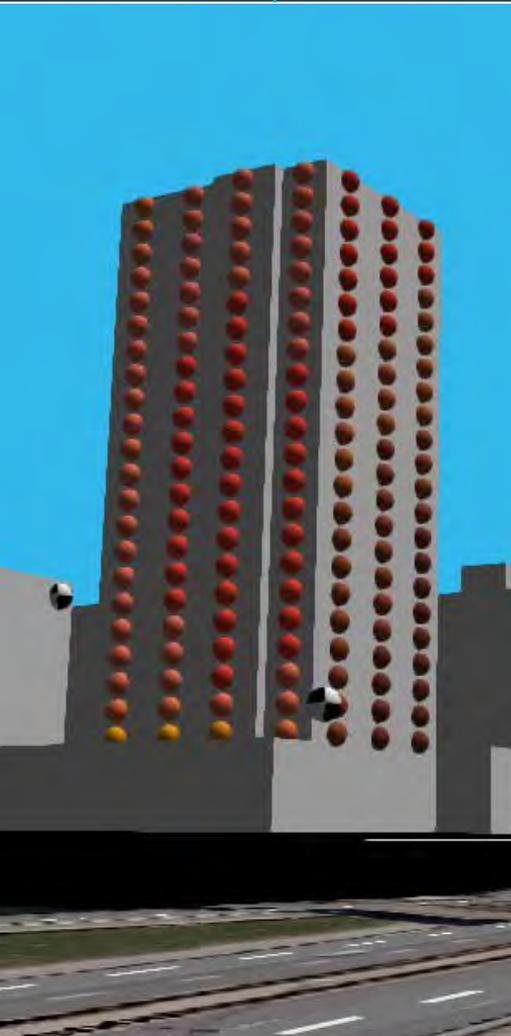
*Dans le pire des cas, soit un niveau en façade de 72 dBA le critère de 40 dBA (LAeq24h) est respecté dans une chambre avec 50% de fenestration avec un vitrage non laminé (3-13-6) et 135% de fenestration avec un vitrage laminé (6Lam-13-6).*
