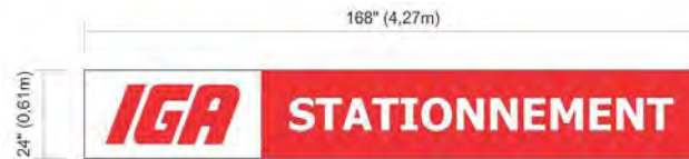
50mm H Vue de face • BOITIER S/F LUMINEUX "PUSH THRU"
