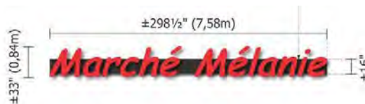
C LETTRES CHANNEL LUMINEUSES SUR CARRIER BOX
