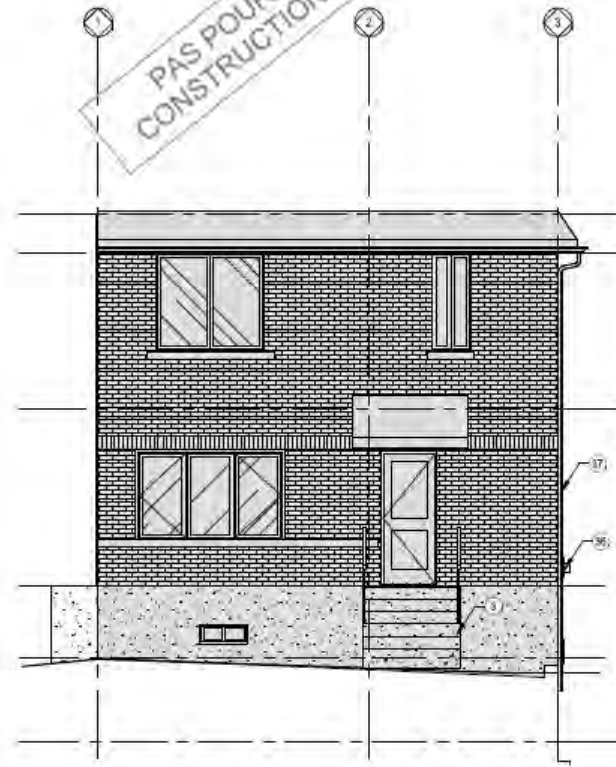
1 ÉLEVATION AVANT - EXISTANT/DÉMOLITION 3/16" = 1'-0"
