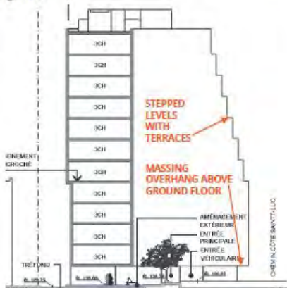
Image 6: Section transversale, vue vers le nord-est
