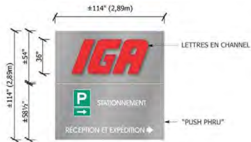
Item F VUE DE FACE • BOITIER S/F LUMINEUX "PUSH THRU" ET LETTRES EN CHANNEL
