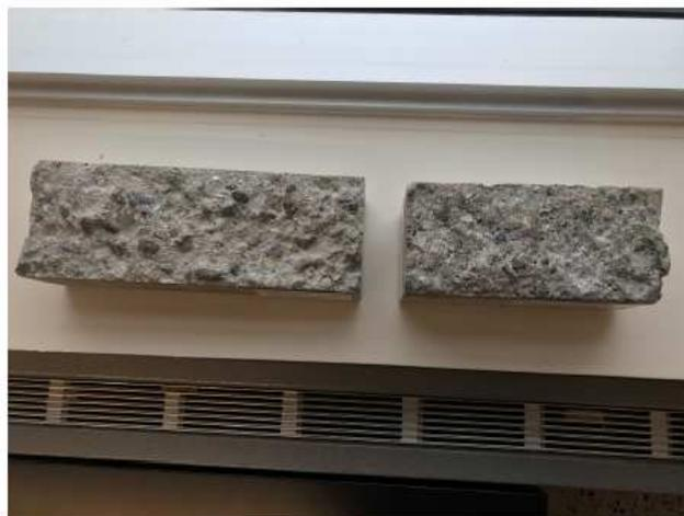
Photo 2. La brique de béton originale (côté droite) et l'échantillon de la nouvelle brique (côté gauche) fait par Permacon
