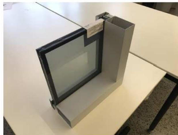
Photo 3. Nouvelle section de la verrière avec un verre fumé. La plaque de pression sera rouge tel que l'existant
