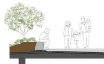
MURET - BANC ET CONCEPT DES BUTTES SUR TREFOND
