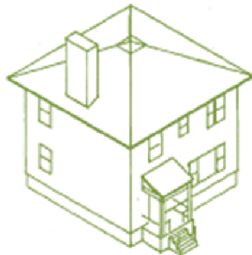
Toit à versants
