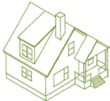
Toit à versants
