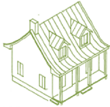
Toit à versants
