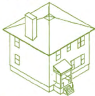
Toit à versants
