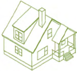
Toit à versants
