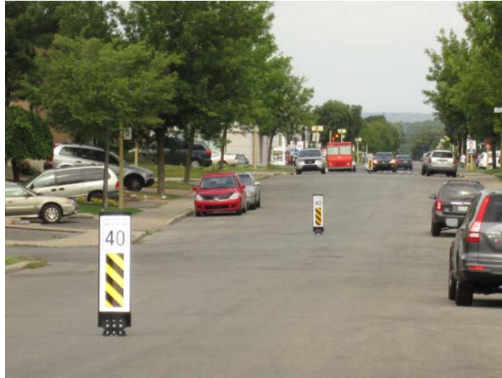
Figure 1. Balises pour l'apaisement de la circulation sur la 27 e Avenue.
